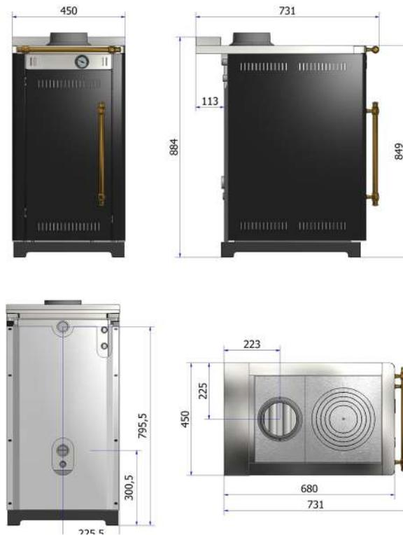
VIKI 45 è una termocucina in acciaio per il riscaldamento civile a legna: collegata all'impianto idraulico vi riscalda tutta la casa oltre a cucinare sul piano cottura in ghisa. Versione compatta senza forno. Linee squadrate e moderne per questa versione con fianchi in acciaio inox satinato.
